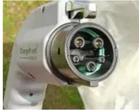
Über den CP-Pin erfolgt die Kommunikation zwischen Ladepunkt und Elektrofahrzeug und über den PP-Pin kann das E-Auto erkennen, ob der Stecker gezogen wird und den Ladevorgang sofort abbrechen, um ein spannungs- und leistungsfreies Trennen des Steckers zu gewährleisten.
